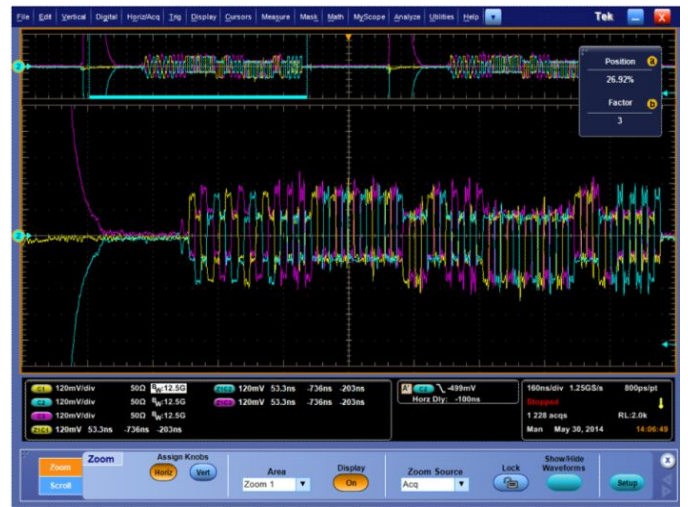
示波器上捕获的 C-PHY 信号
