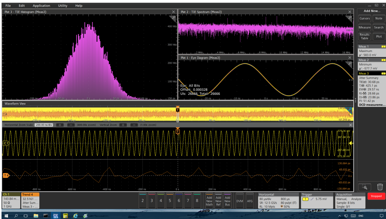
使用 5/6 系列 MSO 测量和选项 5-DJA/6-DJA 测量进行的发射机抖动分析，显示时间间隔误差 (TIE) 值为 30.68 ps
