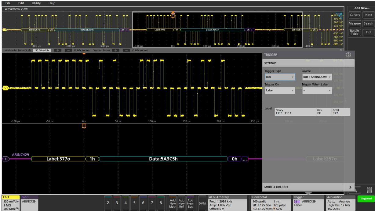
解码的 ARINC 429 总线，在指定的标签值上触发采集。
