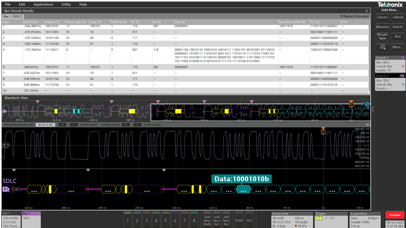
协议解码结果表为 SDLC 总线上捕获的所有包提供了一个带时间标记的表格视图。
