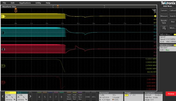
显示电机减速进入停止状态的时间趋势图
