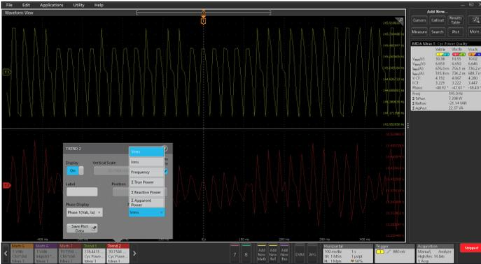
添加并配置功率质量测量不同子测量的时间趋势图。该图显示的是监控 Vrms 和频率参数的两个时间趋势图。
