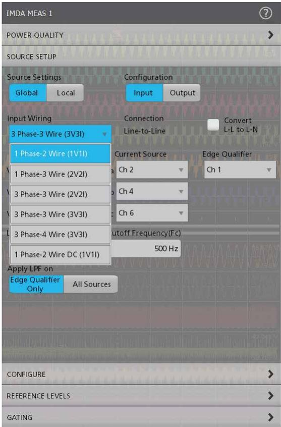
配置输入接线配置的测量
