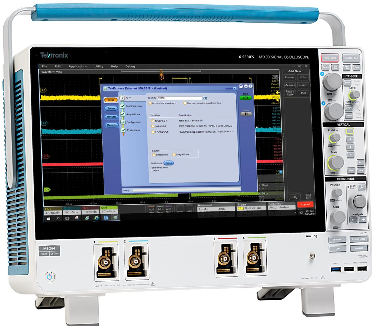
以太网发射机测试应用自动进行 10GBASE-T、NBASE-T (2.5GBASE-T 和 5GBASE-T) 和 IEEE802.3bz (2.5G/5G) 物理介质连接(PMA)物理层(PHY)电接口测试，可以快速准确地测试以太网设计。
