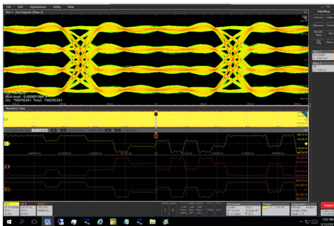
Eye diagram using DPOJET
