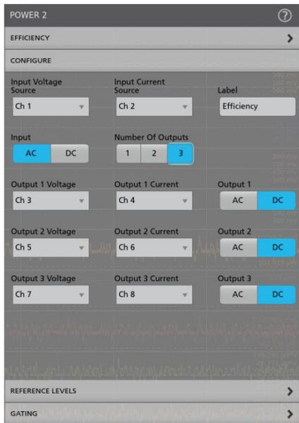
效率测量配置可以测试多输出功率转换器件(AC-DC, AC-AC, DC-DC 和 DC-AC)
