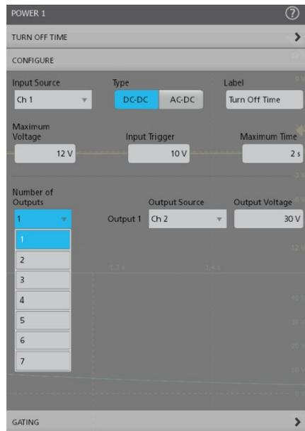
关闭时间测量配置支持多个输出
